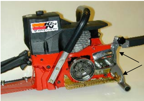
TRIN 5 Påsat SpeedHook® monteringsbeslaget med bolte og låseskiver.
