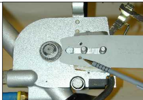
STEG 2: Placera svärd på stöd och kedjans justeringsstift.
