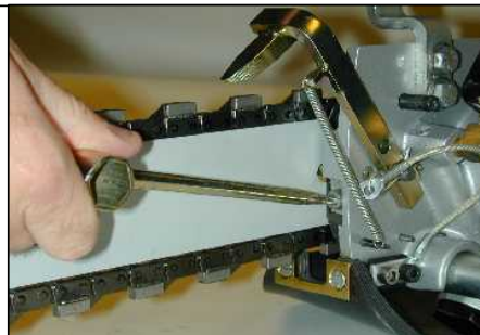
STEG 5: Se till att alla drivlänkar är i svärdets skåror och förspänn därefter kedjan.
