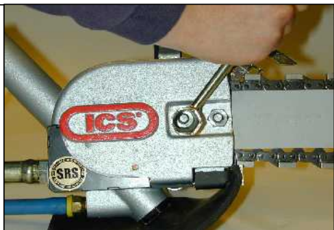
STEG 8: Håll i svärdets spets och skruva fast kedjeskyddets muttrar ordentligt. Se Anmärkning 3.
