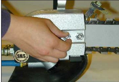
VAIHE 6: Asenna sivusuoja uudelleen paikalleen, kiristä suojan kiinnitysmutterit vain "sormikireyteen".
