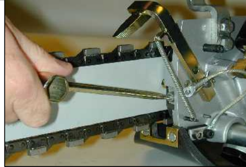
VAIHE 7: Kiristä teräketju. Teräketju ei saa roikkua täysin irti laipasta mutta se pitää voida pystyä pyörittämään laipan ympäri käsin. Katso viite 1 & 2.
