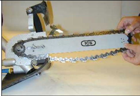
VAIHE 4: Aseta teräketju vetorattaalle ja sitten laipan uraan.
