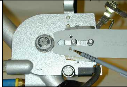
VAIHE 2: Aseta laippa laipan kiinnitysvaarnaruuveille ja säätöruuville.
